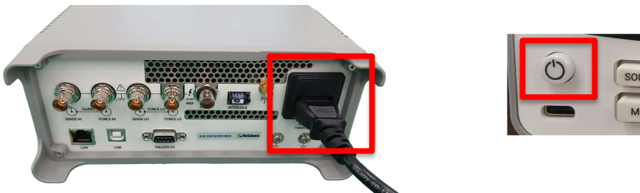
그림. 후면 AC 인렛에 전원을 연결한 모습. 전원 스위치.
