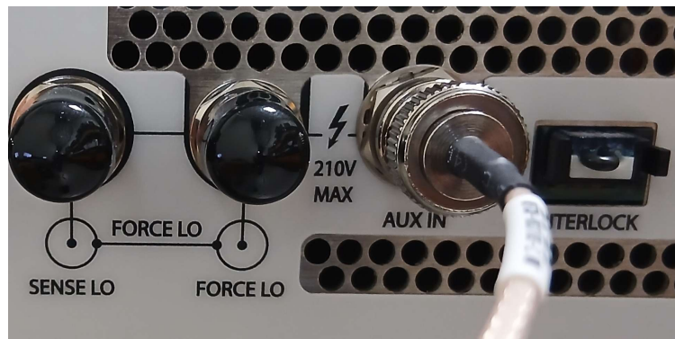
그림. AUX 커넥터와 FORCE LO 사이 도통 위험
